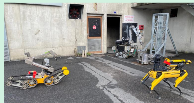
Activité collaborative EDLE (INTRA) - Telemax (KHG) - SPOT (KHG) pour reconnaissance visuelle et radiologique d'un bâtiment accidenté et potentiellement irradiant (présence de sources) et contaminé
