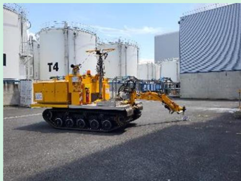
Pose de sonde radiologique par le robot téléopéré ERASE
